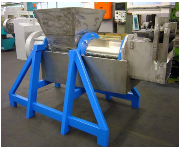
Schneckenpresse LMT 400 mit variabler Presszone
